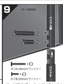
ボード固定板とパイプ上部をパイプ Bに差し込み、パイプの接続部分の 上のネジ穴はネジAで、下のネジ穴 はネジBで固定します。
