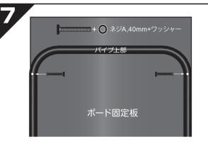
先に、ボード固定板裏面にパイプ上部の上 2個所のみをネジAで取付けます。
